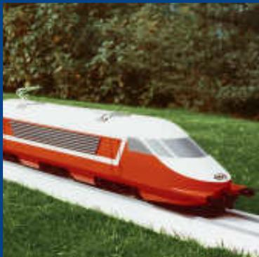
Re 6/6 IV – die 1971 bis 1975 geplanten, aber nie gebauten SBB-Vierstromloks.
