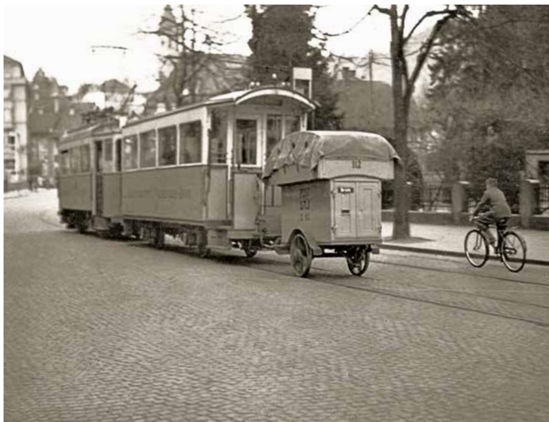
Am 27. März 1948 steht der Zug nach Steffisburg abfahrtsbereit vor dem Thuner Bahnhof. Dem Ce 2/2 folgen C 54 und Z 112. Werktags musste zwingend ein Postanhänger einsatzfähig sein. Daher standen zwei dieser Einachser zur Verfügung, wovon der Zweite meistens abgestellt blieb. Foto Sammlung Verkehrshaus der Schweiz
