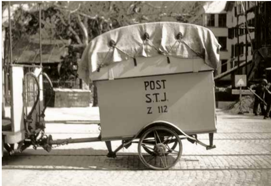
Typenbild des S.T.J.-Z 112, aufgenommen am 27. März 1948 auf dem Bahnhofplatz Thun: Der Aufbau mit Planenabdeckung ist neueren Datums und sorgt für die Vergrößerung der Ladekapazität. Das Wenden des Fahrzeuges auf der Strasse verlangt weniger Kraft als ein Abdrehen der späteren pneubereiften Anhänger. Foto Sammlung Verkehrshaus der Schweiz
